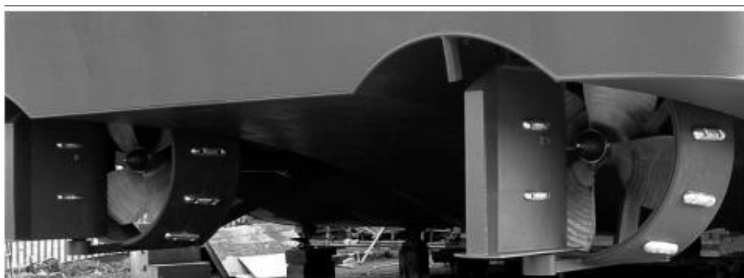
FIGURA 7- Proteção catódica por ânodo de zinco em casco de navio.
