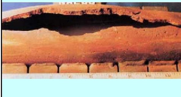
Ruptura em um tubo de caldeira (pressão de operação: 136 Kg/ cm 2 ) devido A fragilização por hidrogênio.
