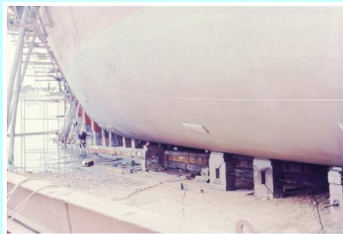
Anodo de zinco fixado em casco de navio.
