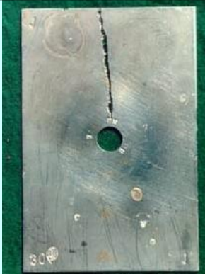
Corrosão por fresta em Aço Inoxidável
