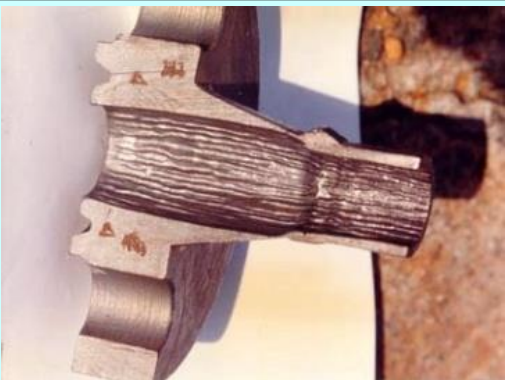
Corrosão por Erosão
