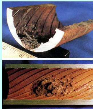
Tubo de 3" de uma caldeira que sofreu ataque cáustico, pressão de operação: 150 Kg/cm 2 .
