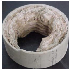
FIGURA 4- Tubulações com incrustações de dureza.
