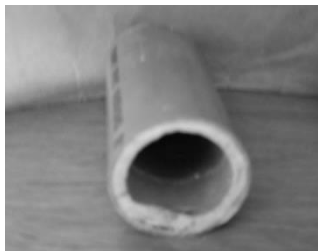
FIGURA 4- Tubulações com incrustações de dureza.
