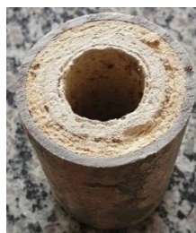
FIGURA 4- Tubulações com incrustações de dureza.
