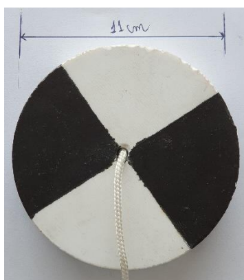
Figura 4- Discos de granito para avaliação da turbidez/claridade de águas de piscinas.
